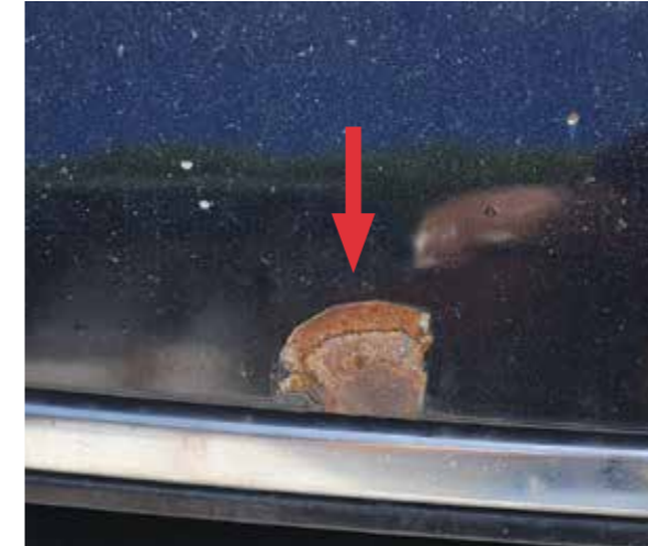
Große Steinschläge mit Rost
