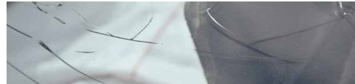
Bruch der Windschutzscheibe
