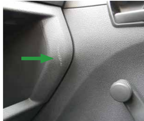
Leichter Kratzer an der Innenverkleidung
