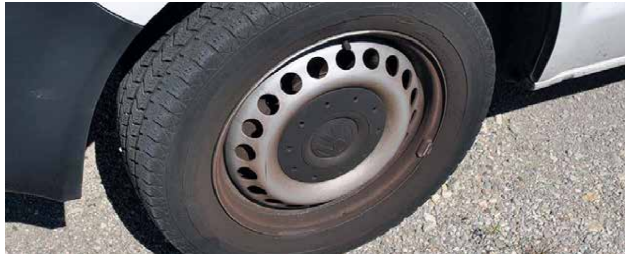
Stahlfelge leicht angerostet aber nicht beschädigt
