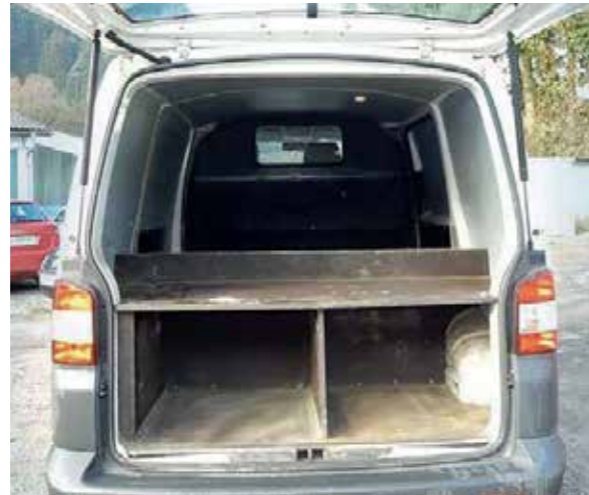
Genehmigte und korrekt installierte Einbauten
