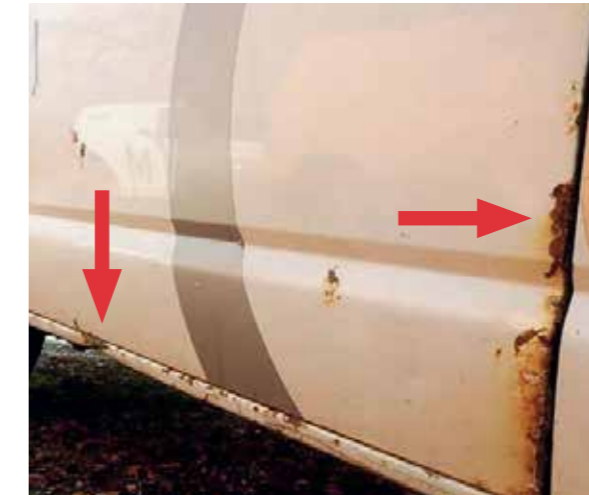
Fahrzeug stark angerostet
