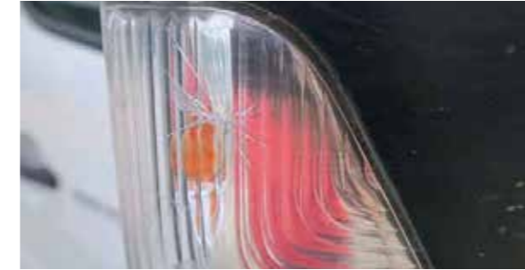
Glasbruch am Blinker
