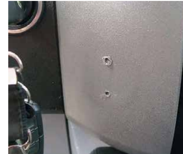
Bohrloch im Armaturenbrett
