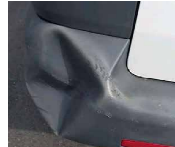
Kunststoffstoßstange stark beschädigt
